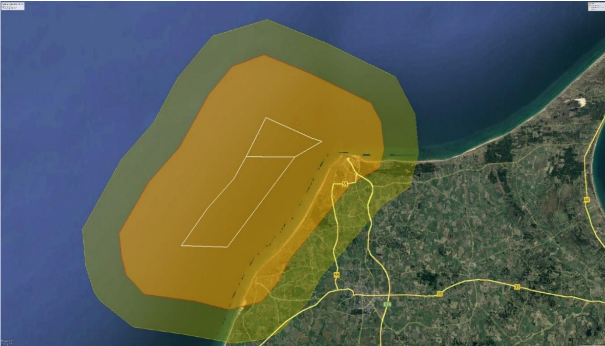
Billede 1. Støjudbredelse fra havvindmølleprojekt i Hirtshals Syd område 1b og område 2. Gul farve viser luftbåren bredspektret støj ved en vindhastighed på 8 m/sek. - 39 dB(A). Grøn farve angiver luftbåren lavfrekvent støj ved en vindhastighed på 8 m/sek. - 20 dB.
